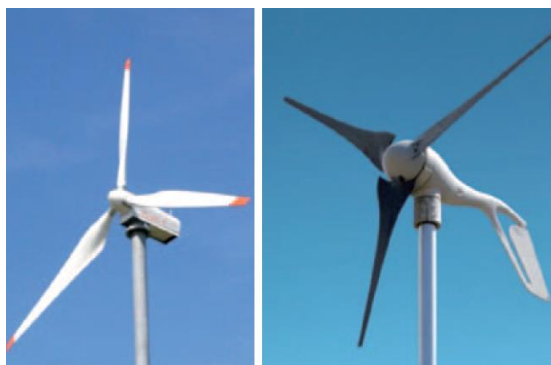
Rysunek 20. Turbiny o poziomej osi obrotu. 124
